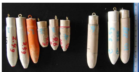
図 4. 各種質量ノーズコーン(ハルサ、穴をあけ粘土で調整、木材・・・)
