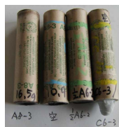
図 5. 粘土を詰めたダミーエンジン。重心 CG 測定用
