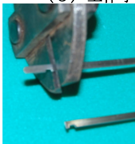
①洗浄・溝を残して先端カット
