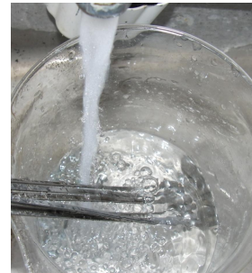
⑦冷えたらフラックス(酸?)落 としの水洗(半田ごて先も)
