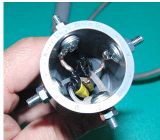
②配線の様子 4φネジで固定 (外径40mm)
